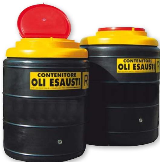
Tanque de armazenamento de óleo usado, com parede dupla em polietileno (um interno em contato com o óleo e outro externo que serve como recipiente de contenção e segurança para o interno).
