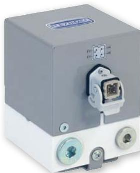
Emissor de pulsos (Pulser) com engrenagens ovais com corpo IXEF. Completo, ou seja, com válvula solenóide de aço inoxidável, filtro de cartucho 150 µm e suporte de fixação. Adequado para fluidos à base de água e uréia (Arla 32 / DEF / AdBlue®).
