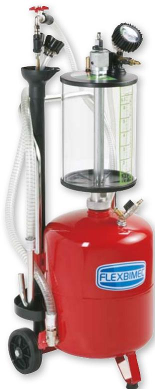
Unidade móvel de sucção de óleo usado, com recipiente de coleta de capacidade de 24 l e câmara de inspeção transparente de capacidade de 6,5 l, incluindo manómetro de nível, mangueira de sucção, kit de sondas de sucção em diferentes diâmetros (consulte a página 127!), Adaptadores de sucção e tigela de armazenamento. A unidade pode ser descarregada pneumática conectando-a ao ar comprimido através de uma mangueira de descarga com tubo de saída curvo.
