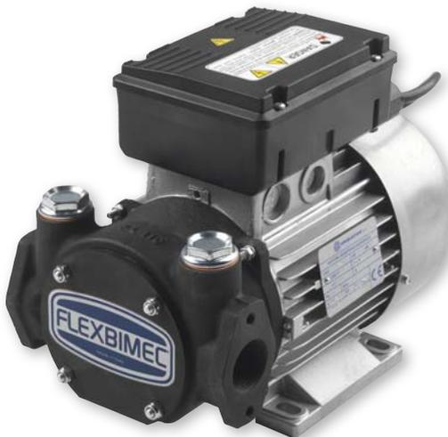
Bomba elétrica, auto-sucção, 230 V, para transferência de diesel. Rotor em aço sinterizado e palhetas em resina acetel. A bomba possui uma válvula de bypass embutida; categoria de proteção IP 55. Entrega 100 l/min a 1420 rpm.
