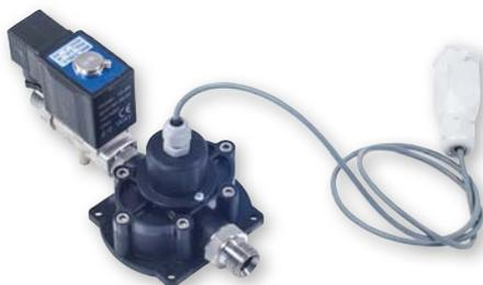
Medidor de fluxo eletrônico de engrenagens ovais com transmissor de pulso, corpo em IXEF, incluindo uma válvula solenóide de aço inoxidável. Adequado para uso com líquidos à base de água e Arla 32 / DEF / AdBlue®. Adequado ao uso em combinação com sistemas eletrônicos de monitoramento de óleo pela utilização de um receptor externo.
