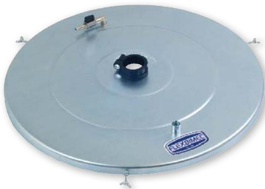
Tampa de tambor de metal, incluindo adaptador de fecho de metal e contra-anel de metal, adequado para o uso de bombas de graxa pneumática da série "Power Bull" em 180 kg - bateria. Diâmetro total 600 mm, diâmetro do furo para tubo de sucção no adaptador de folga de 50 mm. Adequado para os artigos números 4048 - 4049 - 4050 - 4051 - 5090.
