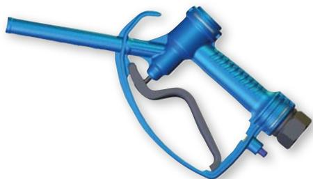
Bicos de abastecimento de plástico para AdBlue®, componentes internos em aço inoxidável, selos Viton®, peças internas e saída de distribuição rígida (ø 18,8 mm) em aço inoxidável, conexão de plástico e gatilho com trava.
