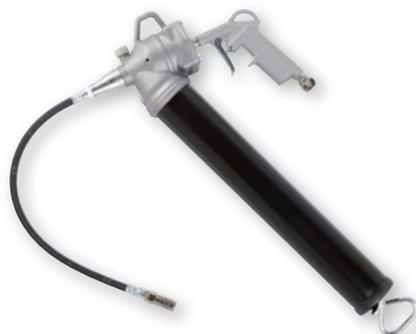
Pistola de graxa pneumática, adequada para uso com graxa em massa ou com cartuchos de graxa. Com a mangueira de aço trançada  $\varnothing$  ext. 8 mm x 300 mm de comprimento, M 10 x 1 e 4 - mandíbulas 4 acopladores hidráulicos. É um mecanismo de ação único (fonte de graxa não contínua): ao ativar o gatilho, o pistão interno se move e fornece graxa; quando o gatilho é liberado, o pistão retorna em sua posição inicial. Ao repetir este procedimento, a graxa pode ser dispensada.
