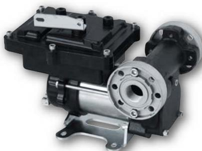
Elétrico, auto-pressionado 12 Vcc - bomba de palheta rotativa (disponível também em 230 VAC) para transferência de gasolina, com corpo pintado em ferro fundido com revestimento anticorrosivo, filtro anti-ruído (compatibilidade eletromagnética EMC), proteção térmica, não retorno válvula, válvula de alívio de pressão, válvula de derivação embutida e 2 m de cabo com braçadeiras com garra para conexão da bateria.
