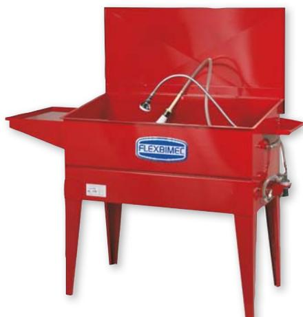
Limpador de peças em aço pintado, com circuito fechado de fluido detergente, constituído por bacia de limpeza com 4 pés e tampa fechável e removível, mangueira com chuveiro, escova de limpeza permeável a fluidos que permite um fluxo contínuo do detergente e uma limpeza precisa de partes. O sistema permite uma circulação contínua de fluidos pelo uso de uma bomba rotativa pneumática em aço inoxidável (Art. n.º. 1058).
