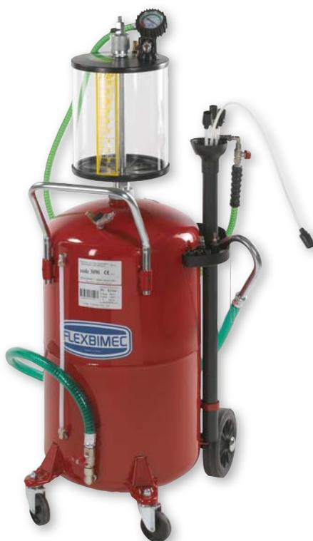
Unidade de sucção móvel de óleo usado, com recipiente de coleta de capacidade de 90 l e câmara de inspeção transparente de 10 l de capacidade, incluindo manómetro de nível, mangueira de sucção, kit de sondas de sucção em diferentes diâmetros (consulte a página 127!), Adaptadores de sucção e tigela de armazenamento. A unidade pode ser descarregada pneumática conectando-a ao ar comprimido através de uma mangueira de descarga com tubo de saída curvo.
