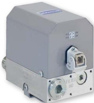
Medidor de fluxo eletrônico de engrenagens oval com transmissor de pulso, adequado para óleo, diesel e anticongelante, incluindo uma válvula solenóide, um filtro de 150 µm em linha e um suporte de parede. Adequado ao uso em combinação com sistemas eletrônicos de monitoramento de óleo pela utilização de um receptor externo.
