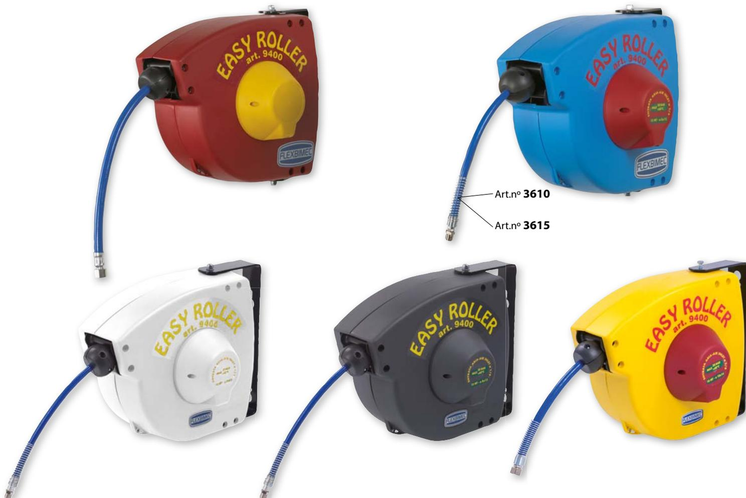
Rebobinamento automático, com mola, com gabinete de plástico (de nylon e polipropileno) e suporte de parede giratório, adequado para uso com ar comprimido e água (temperatura: -10 ° C - + 60 ° C) e para mangueiras de 8 x 12 mm (ou 10 x 14 mm) com um max. Comprimento de 15 m (ou 10 m).
