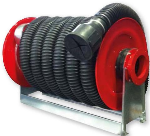
Rebobinamento automático, movido por mola, em aço pintado, fornecido para a extração de exaustão, com mangueira à prova de esmagamento em diferentes diâmetros e comprimentos, amortecedor de batente de mangueira e bocal de bico com tampa do diafragma.
