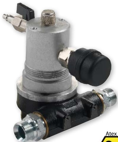
Bomba de palheta pneumática, auto-rectificadora para transferência de gasolina, com corpo em ferro fundido com revestimento anticorrosivo e rotor de plástico. Cabo terrestre para permitir uma descarga eletrostática a pedido.
