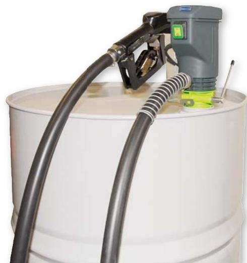
Kit de transferência de diesel, composto de bomba elétrica de 12 Vcc, 24 Vcc ou 230 V, cabo de 3 m com braçadeira de jacaré para conexão da bateria (12 Vcc e 24 Vcc) ou cabo de 2 m com ficha de tipo terra, 1,6 m - mangueira de sucção com filtro de pé, 4 m - mangueira de borracha Ø 3/4" com mola anti-torção, cauda de mangueira e bocal de distribuição automática com giro de entrada.
