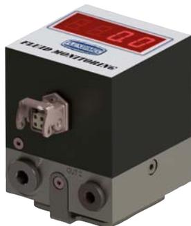
Emissor de pulsos (Pulser) com engrenagens ovais, compatível com óleo lubrificante, anticongelante e diesel. Completo, ou seja, com válvula solenóide, filtro de cartucho 150 µm e suporte de fixação. Adequado para interface com sistemas de gerenciamento e monitoramento e fluidos via receptor externo.
