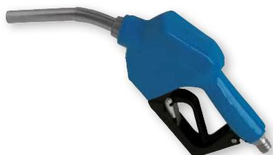
Bicos de abastecimento automático para AdBlue®, corpo com proteção de borracha, com juntas Viton®, peças internas e saída de distribuição rígida (ø 19 mm) em aço inoxidável, cauda íva de tubo flexível ø 19 mm.
