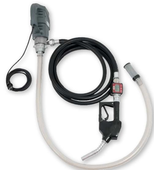
Bombas para transferência elétrica e híbrida de diesel, óleo combustível, bio-diesel (com mangueiras adequadas), anticongelante (com ou sem água), adequado para montagem direta em tanques. Estas bombas são autoprimum, categoria de proteção IP 54, com interruptor ON / OFF e uma conexão integrada thread BSP 2".
