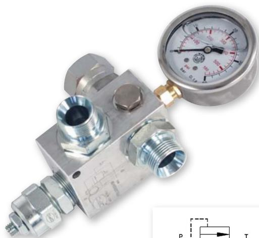
Válvula de alívio de pressão, adequada para tubos de lubrificação. Corpo em liga de alumínio e cartucho em aço galvanizado. Inclui manômetro de glicerina com graduação de 0 a 60 bar e parafuso de regulação para a seleção do max. pressão aplicável. Conexões (BSP): entrada F - saída M.
