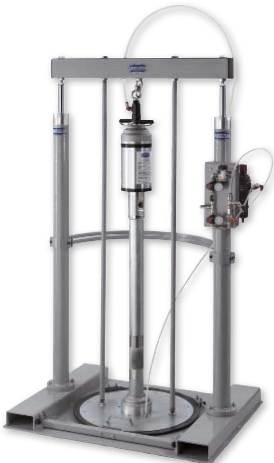
Unidade de extrusão para graxa com placa, constituída por um dispositivo de elevação de bomba especial adequado para bombas de graxa pneumática, série "Power Bull" e um sistema de compactação de graxa que funciona com base em um circuito pneumático que é ativado por uma válvula de controle.
