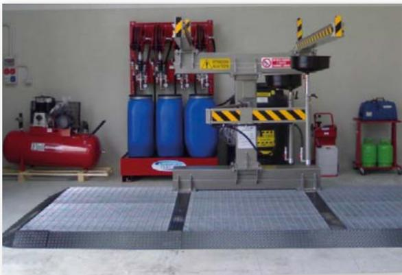
Rampa do veículo em aço pintado, incluindo escada com plataforma de trabalho. Permite um ótimo acesso ao veículo tanto pela parte de baixo, como por cima. A rampa possui um piso de segurança de contenção de derramamento com grelhas galvanizadas para o recolhimento correto de fluidos que eventualmente respinguem ou vazem.
