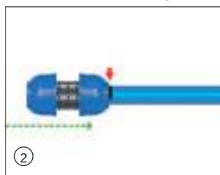
Inserción del accesorio hasta la señal
