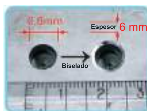
- Diámetro y espesor mínimo para el inicio del biselado.
